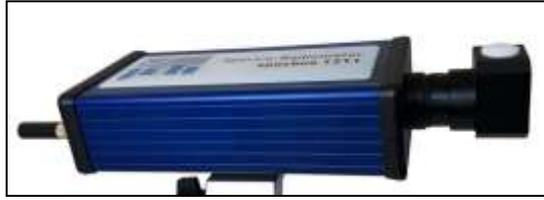
Spectroradiomètre (le capteur est la zone blanche à droite)
